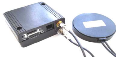
Bild: HETP STS mit externer Kombi-Antenne
